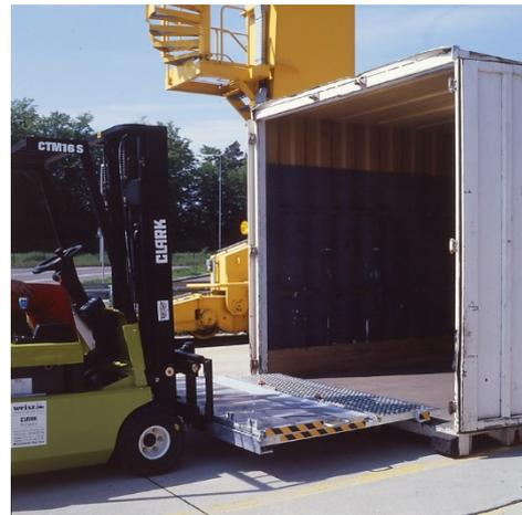
Diese mobile Überfahrbrücke wurde für das Entladen von Containern konzipiert. Sie ist geeignet für das Befahren von Staplern mit bis zu 6000 kg Gesamtbelastung. Eingebaute Staplerlarschen erleichtern den schnellen Ladeortwechsel, 2 Ketten dienen der Sicherung am Container. Die Überfahrbrücke ist erhältlich standardmäßig in vier verschiedenen Größen / Längen. Die Höhenunterschiede können bis zu 295 mm betragen.
