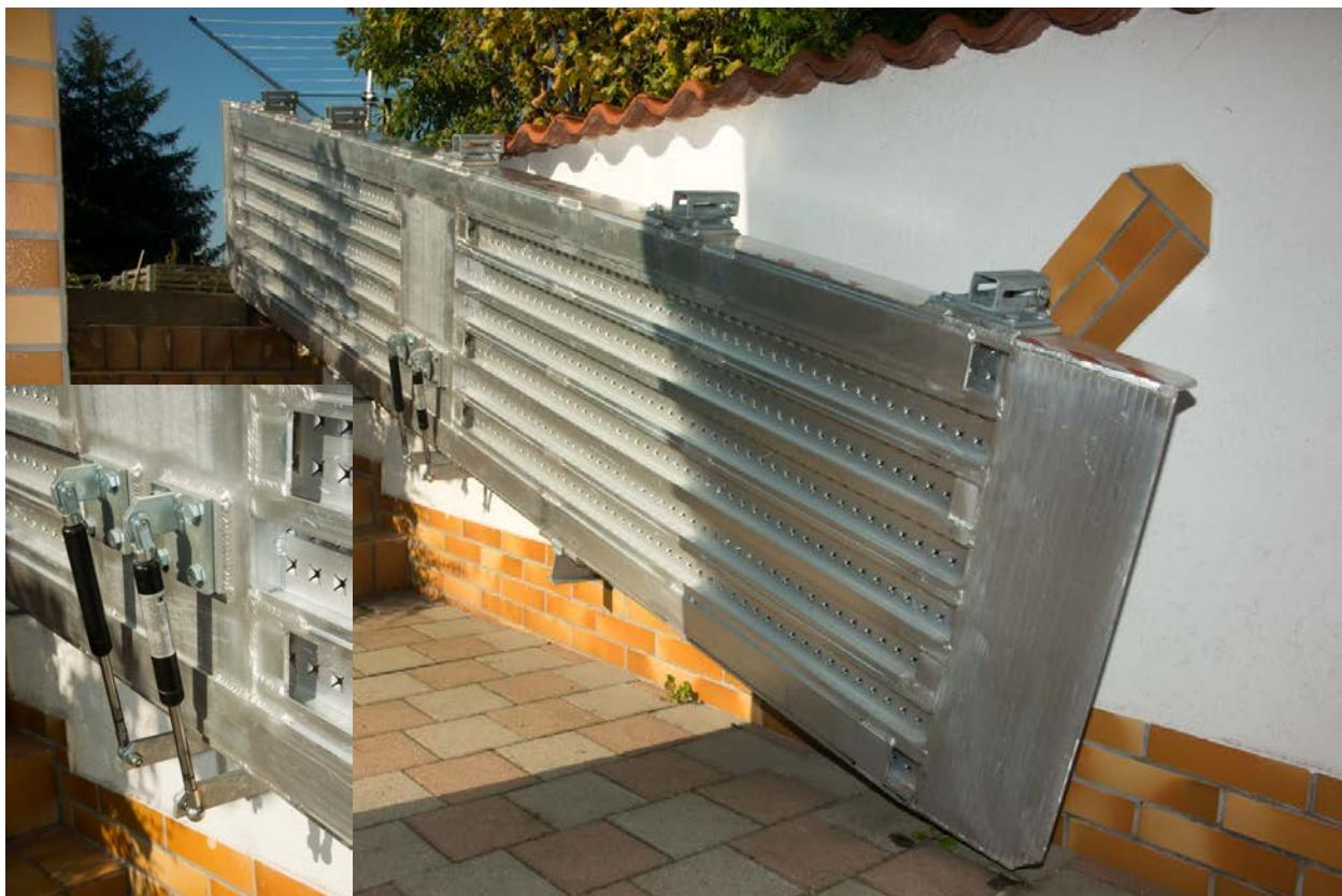
Der Klappmechanismus kann rechts oder links verbaut werden. Da die Rampe vormontiert geliefert wird, bitte gewünschte Variante angeben. Entscheidend für Variante "Rechts/Links" ist die Position der Wandhalterung, betrachtet von dem unteren Ende der Rampe nach Richtung oberes Ende. Die minimale Höhendifferenz beträgt 290 mm.
